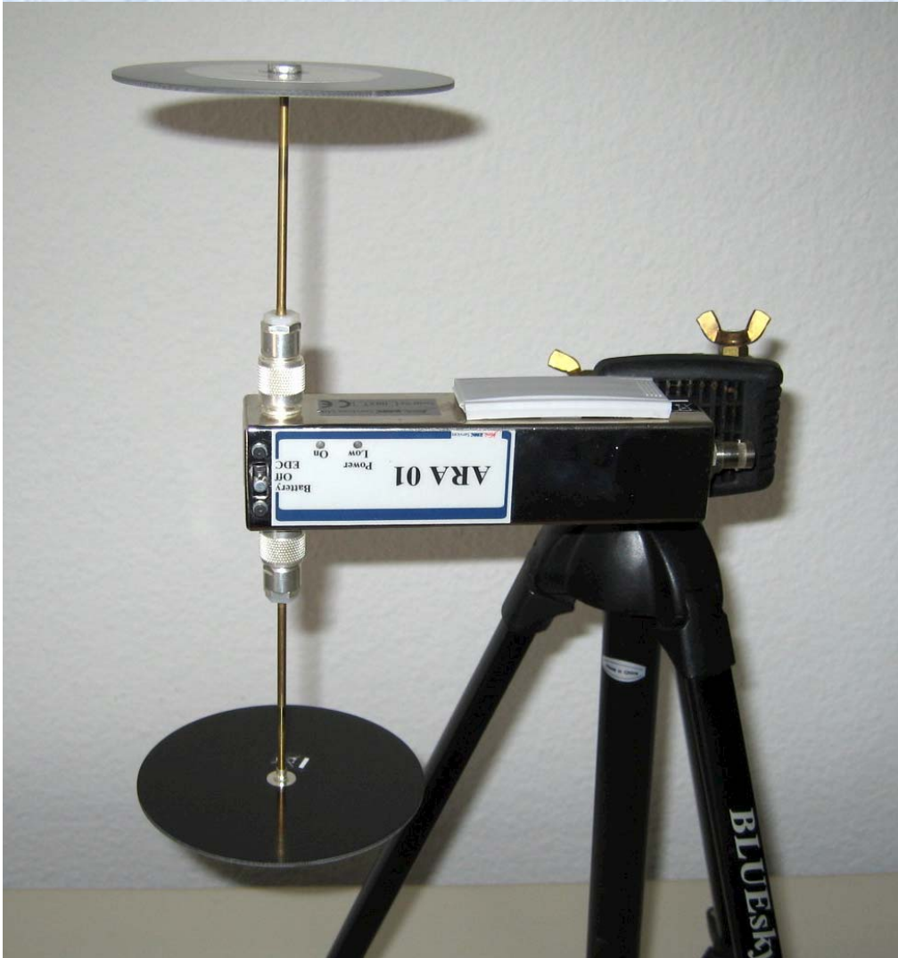
Antenne ARA01 commerciale B.P. : 100 MHz à 1 GHz
