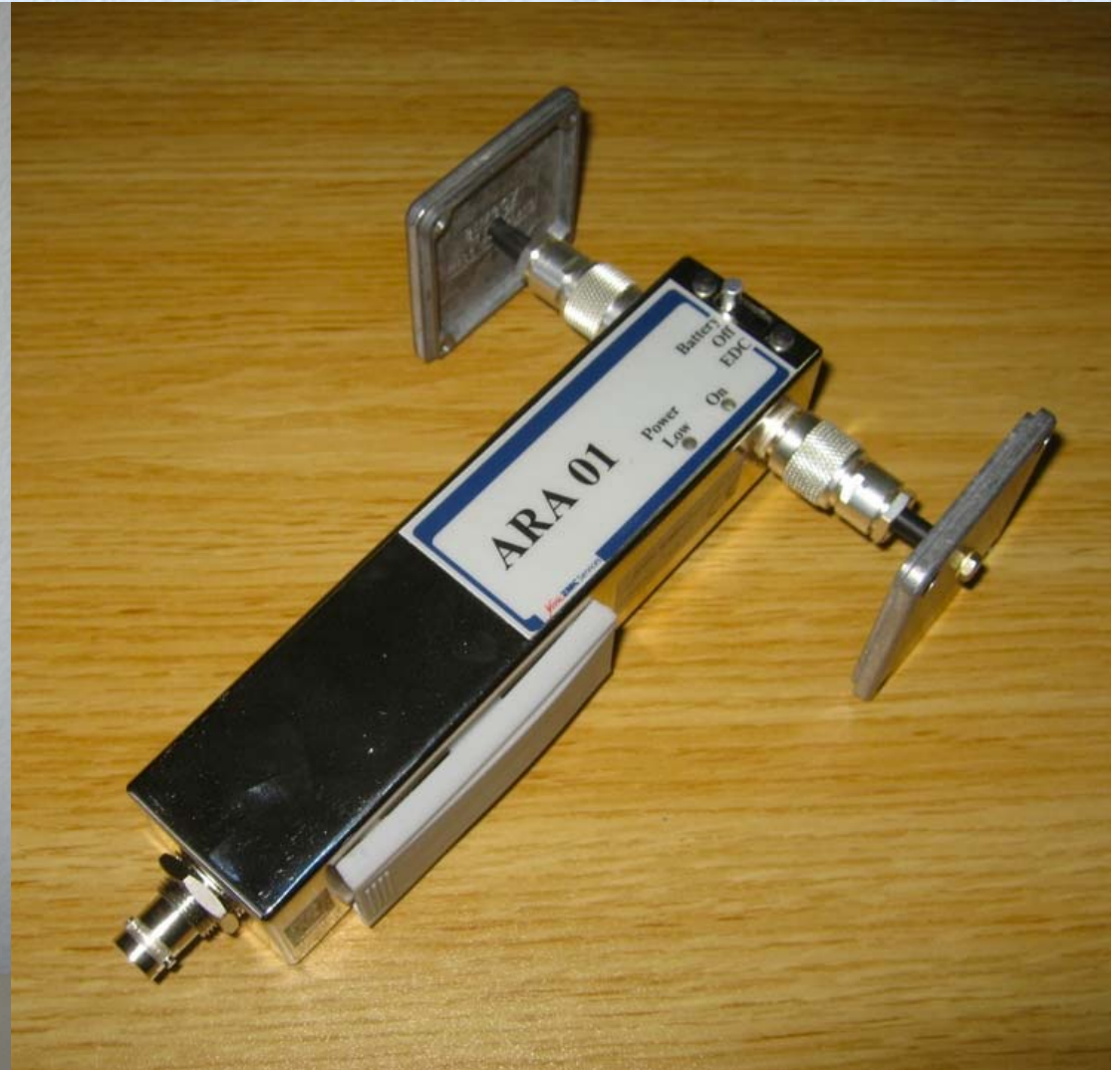
Antenne ARA01 modifiée B.P. : 200 MHz à 2,5 GHz
