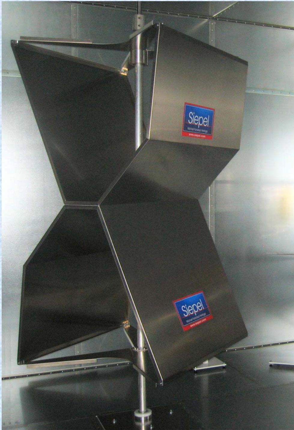
Après une mesure en « Max-hold » (ou « peak-mem »), un brasseur de modes rotatif permet de rendre l'enveloppe du champ mesuré peu variable avec la direction de l'émission, la polarisation, le pointage de l'antenne de réception et la géométrie des câbles. En outre, la variation des couplages en fréquence est « douce ».
